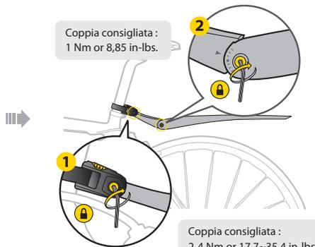
1 2 Regolare il DeFender™ iGlow per una corretta angolazione e distanza dalla ruota. Ristringere le viti di regolazione una volta raggiunta la corretta angolazione.
